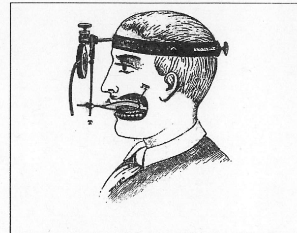
Abb. 4: Gerät zur Registrierung der Bewegung des Gaumensegels (aus: Rousselot 1924/I, S. 94)
